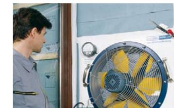
Lorsque tous les raccords sont réalisés de manière étanche à l'air, la structure d'isolation thermique offre une fiabilité durable. Nous recommandons ensuite de vérifier l'étanchéité à l'air en mesurant la pression différentielle, à l'aide d'un test BLOWER DOOR ou d'un appareil de contrôle pro clima WINCON.
