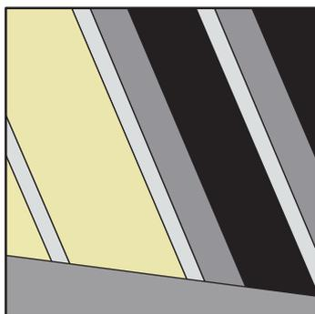
3. Poser les panneaux PAVATHERM directement sous les chevrons éventuellement deux couches et les fixer provisoirement avec des vis, des agrafes ou des clous.
