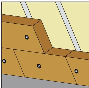
4. Poser un régulateur de vapeur et étancher durablement les recouvrements et les raccords avec les autres éléments de la construction.
