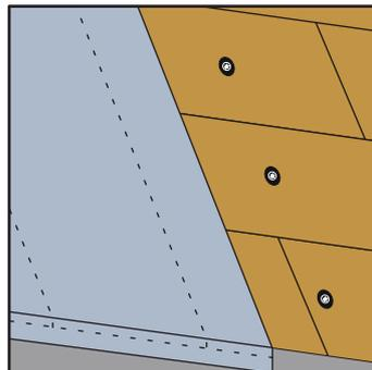
5. Poser une contre-lattage sous le régulateur de vapeur et le fixer avec des vis au travers des panneaux PAVATHERM jusque dans les chevrons.
